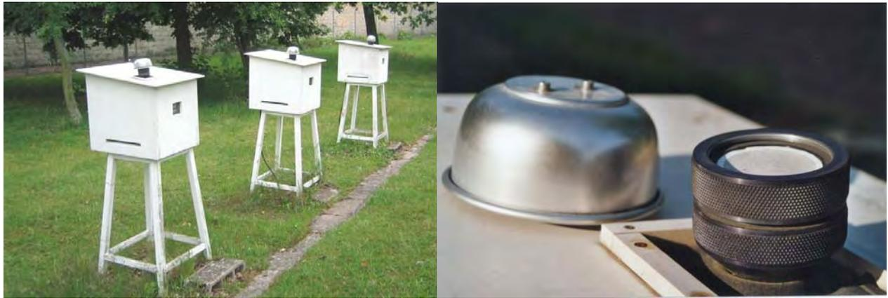
Figure 43 : Photo des stations de prélèvement d'aérosols du site du Vésinet (IRSN) et détail de la tête de prélèvement et du dispositif porte-filtre.
