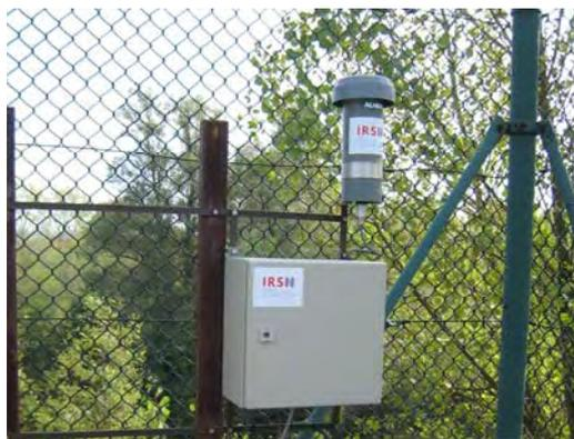
Figure 37 : Photo d'une sonde Téléray (détecteur Geiger Müller)
