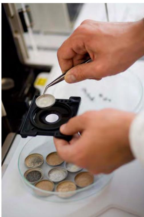
*Figure 10 : Chargement d'un compteur proportionnel en vue de la détermination de l'indice d'activité bêta globale*
