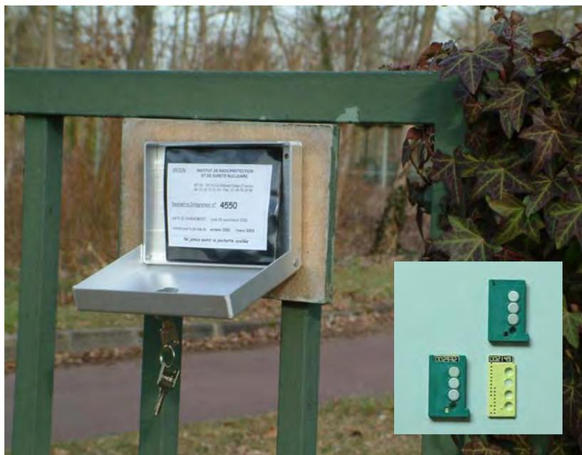
Figure 42 : Photo d'un dispositif DTL
