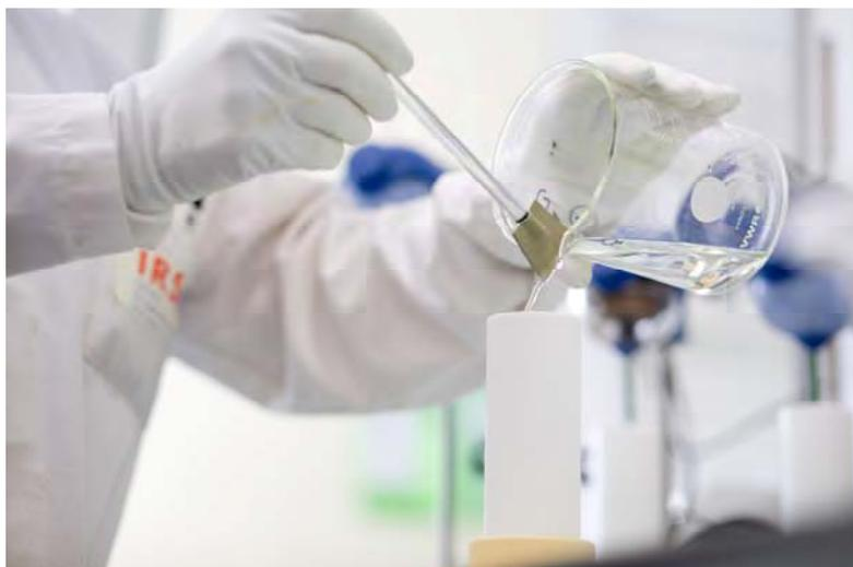
*Figure 9 : Transfert d'une solution aqueuse dans une cellule de déposition pour obtention d'un dépôt en couche mince avant mesure par spectrométrie alpha*
