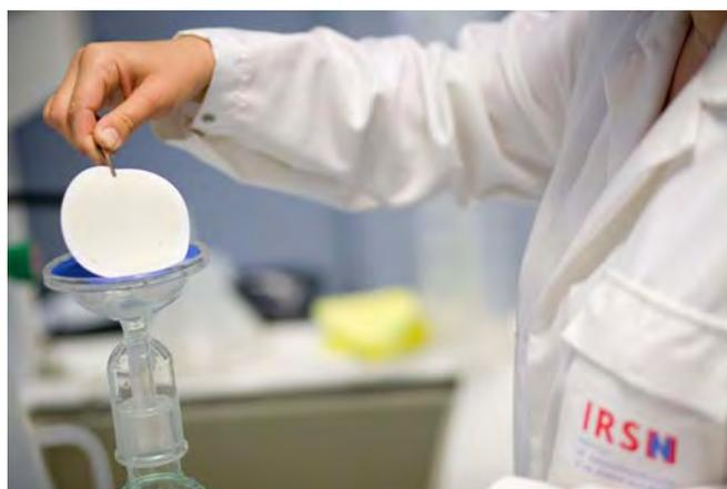
Figure 7 : Récupération d'un papier filtre contenant les matières en suspension d'une eau filtrée
