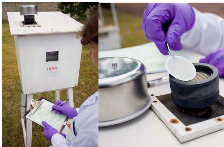
Figure 20 : Station AS du site IRSN du Vésinet (gauche) et prélèvement du filtre (droite)
