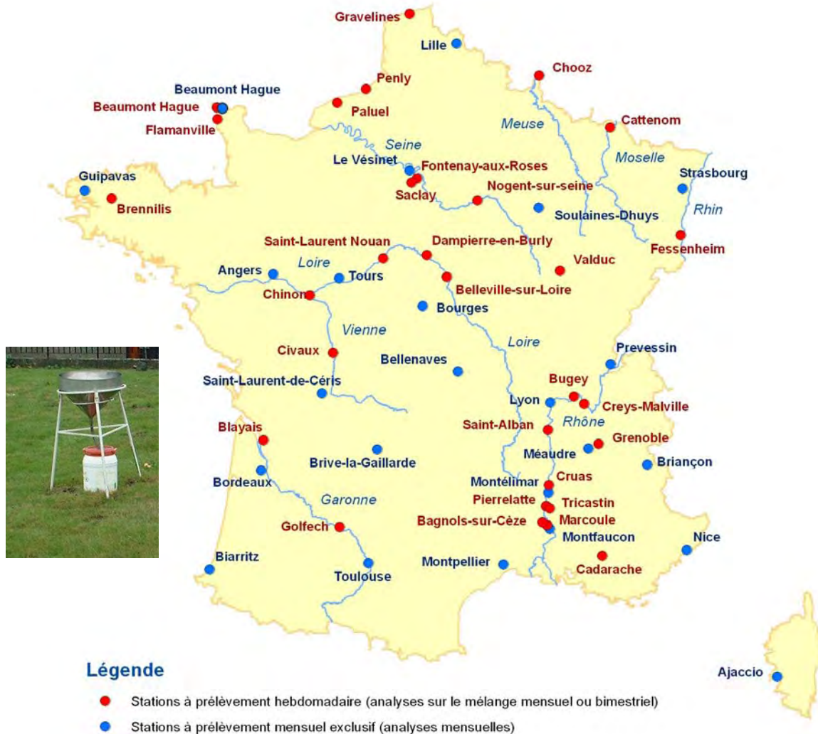
Figure 28 : Photo de collecteur et implantation des points de collecte d'eau de pluie en 2008
