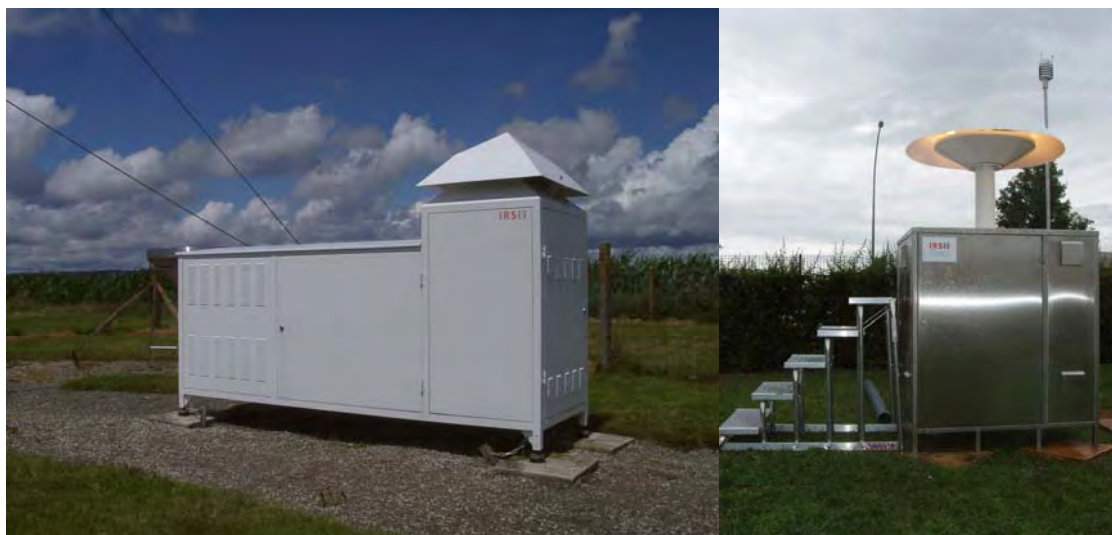
Figure 23 : Stations de prélèvement TGD : version à gauche 300 m 3 /h - version à droite 700 m 3 /h
