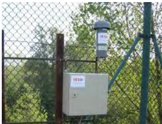
Figure 11 : Photo d'une sonde Téléray (déTECTEUR Geiger Müller)
