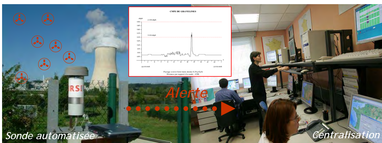
Figure 2 : Sonde Téléray déclenchant une alerte en salle de télésurveillance de l'IRSN
