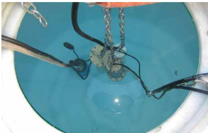
**FIGURE VI.3** Photographie de trois prototypes Téléhydro immergés dans une cuve de test de 5 000 litres.
