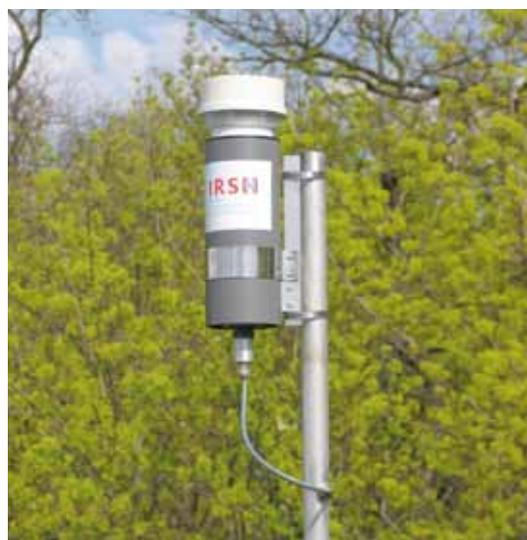
FIGURE III.2 Photo d'une sonde Téléray (détecteur Geiger-Müller).
