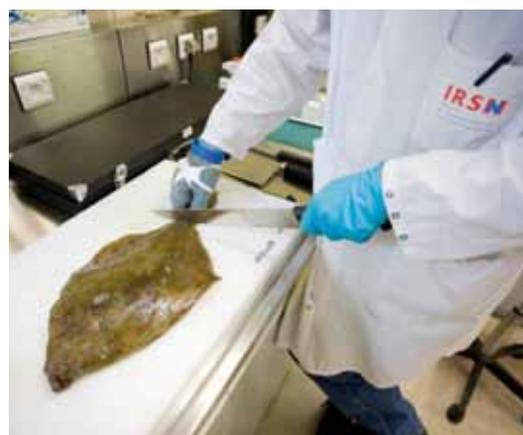
**FIGURE V.16** Photo de traitement de carrelet en vue d'analyse radiologique.
