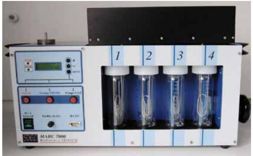
**FIGURE V.6** Photo d'un barboteur tritium.
