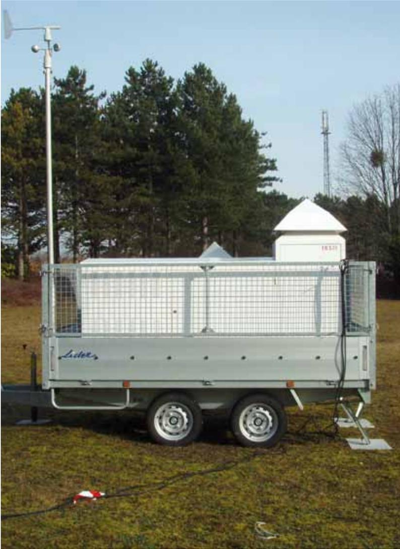
**FIGURE III.45** Dispositif mobile de prélèvement des aérosols à grand débit (300 m<sup>3</sup>/h).
