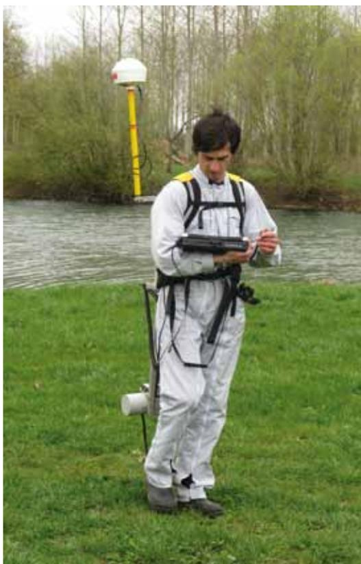
**FIGURE VII.2** Dispositif Socrate de cartographie du débit de dose.
