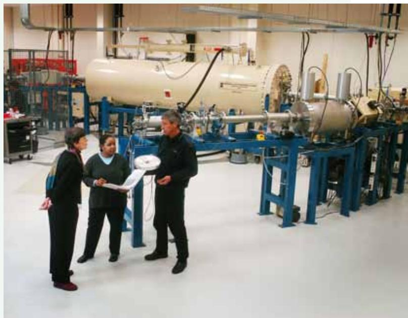
Le spectromètre de masse par accélérateur (AMS) au laboratoire de mesure du carbone  $^{14}$  du CEA.
