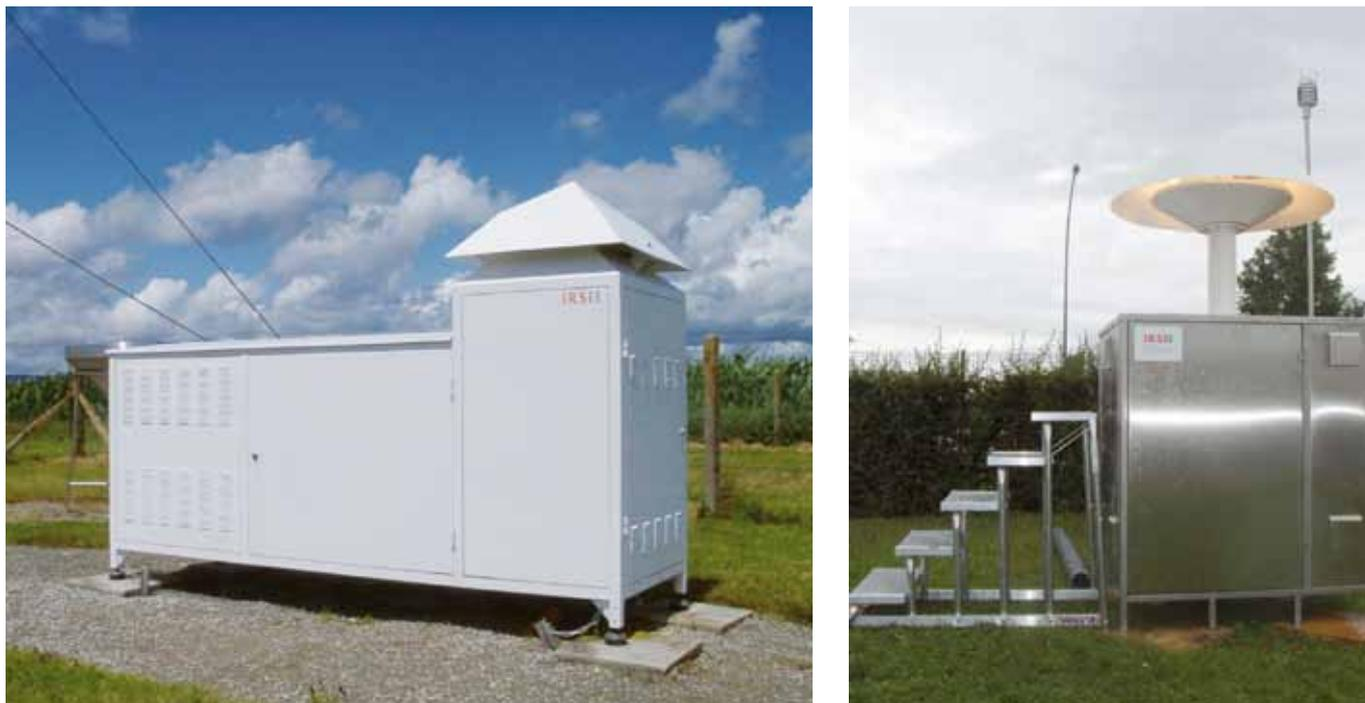
FIGURE III.15 Stations de prélèvement TGD. Version à gauche : 300 m³/h ; version à droite : 700 m³/h.
