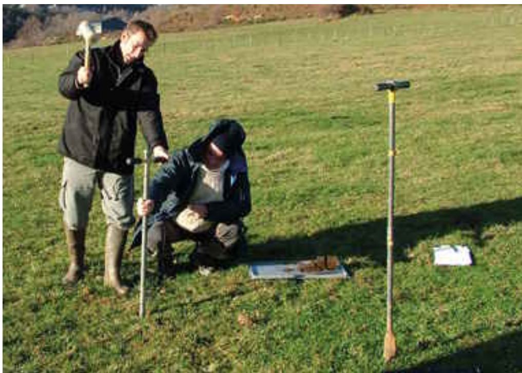
Prélèvement de sol au carottier en Vanoise pour estimer analyser les traceurs en césium, strontium et plutonium rémanente des essais atmosphériques d'armes nucléaires
