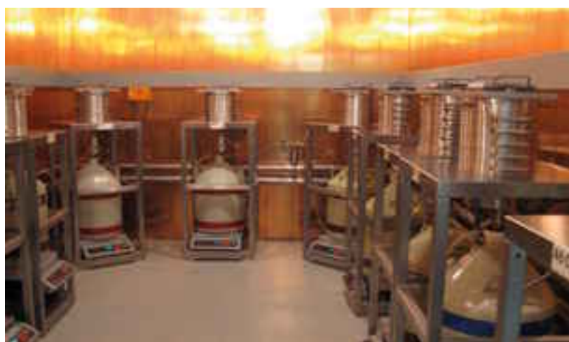
Salle des détecteurs de spectrométrie gamma de l'IRSN à Orsay permettant des mesures de très bas niveaux d'activité
