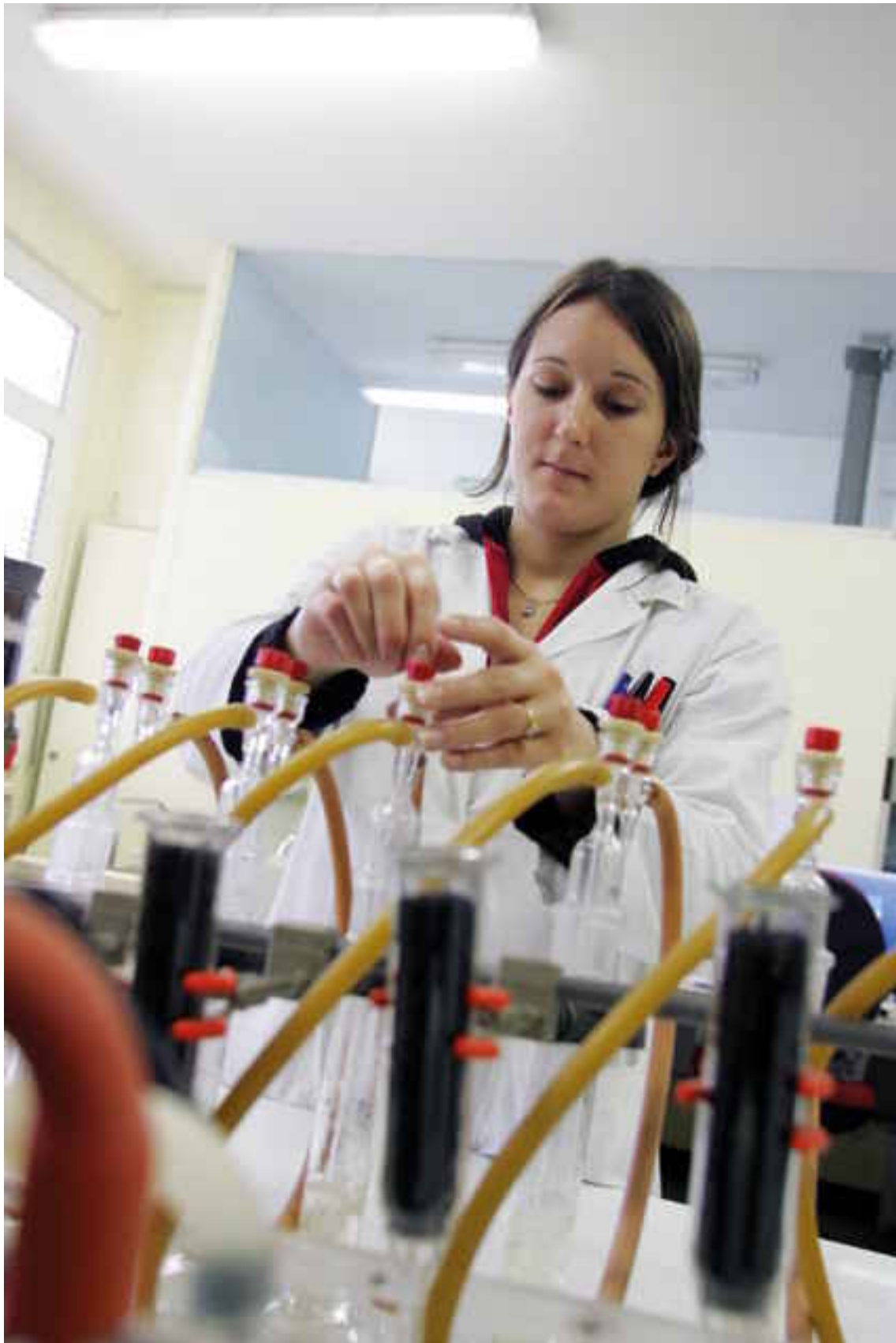
Analyse du radium par émanométrie
