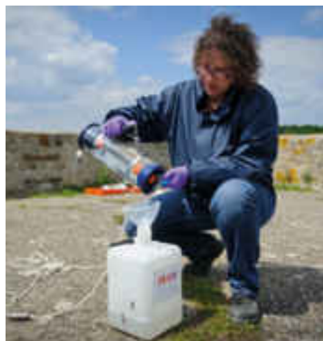
FIGURE 7 / ÉCHANTILLONNAGE PONCTUEL D'EAU À L'AIDE D'UN PRÉLEVEUR HORIZONTAL KEMMERER
