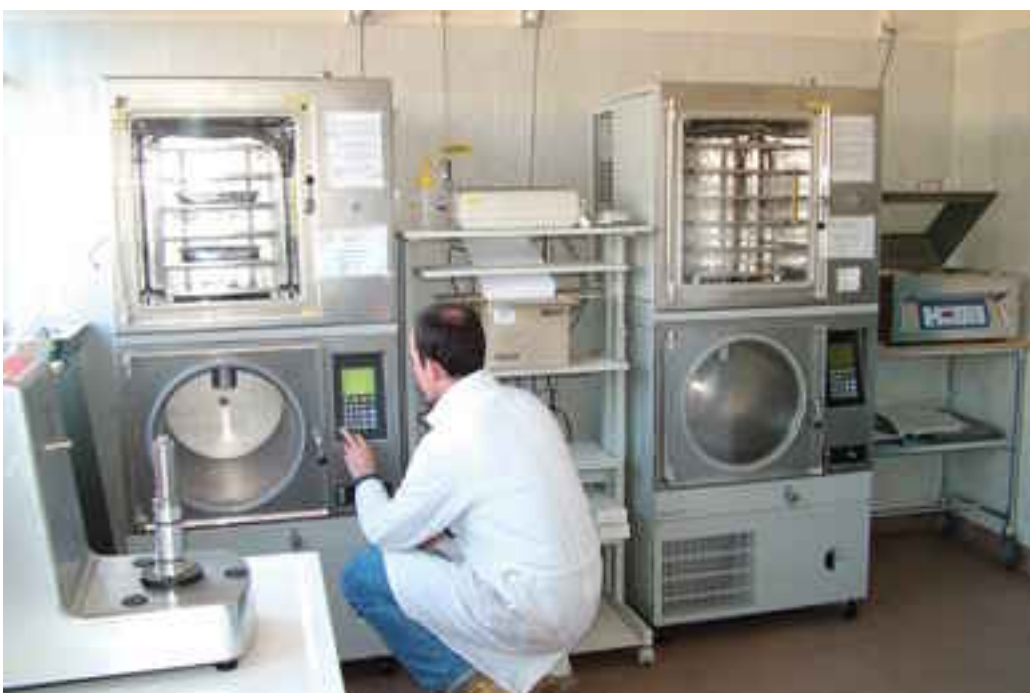
Lyophilisation d'un échantillon préalablement à la mesure du carbone 14
