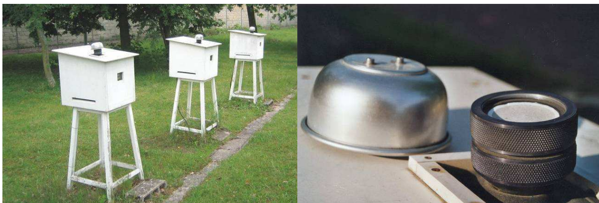
Figure 71 : photo des stations de prélèvement d'aérosols du site du Vésinet (IRSN) et détail de la tête de prélèvement et du dispositif porte-filtre
