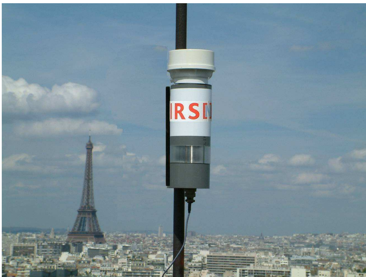
Figure 66 : photo d'une sonde Téléray (détecteur Geiger Müller)
