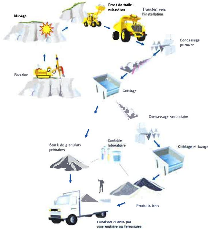
Figure n° 2 : Principales étapes de l'extraction de matériaux en carrières à ciel ouvert
