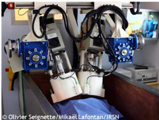
Figure 1 - Mesure anthroporadiométrique pulmonaire à l'aide de détecteurs GeHP
