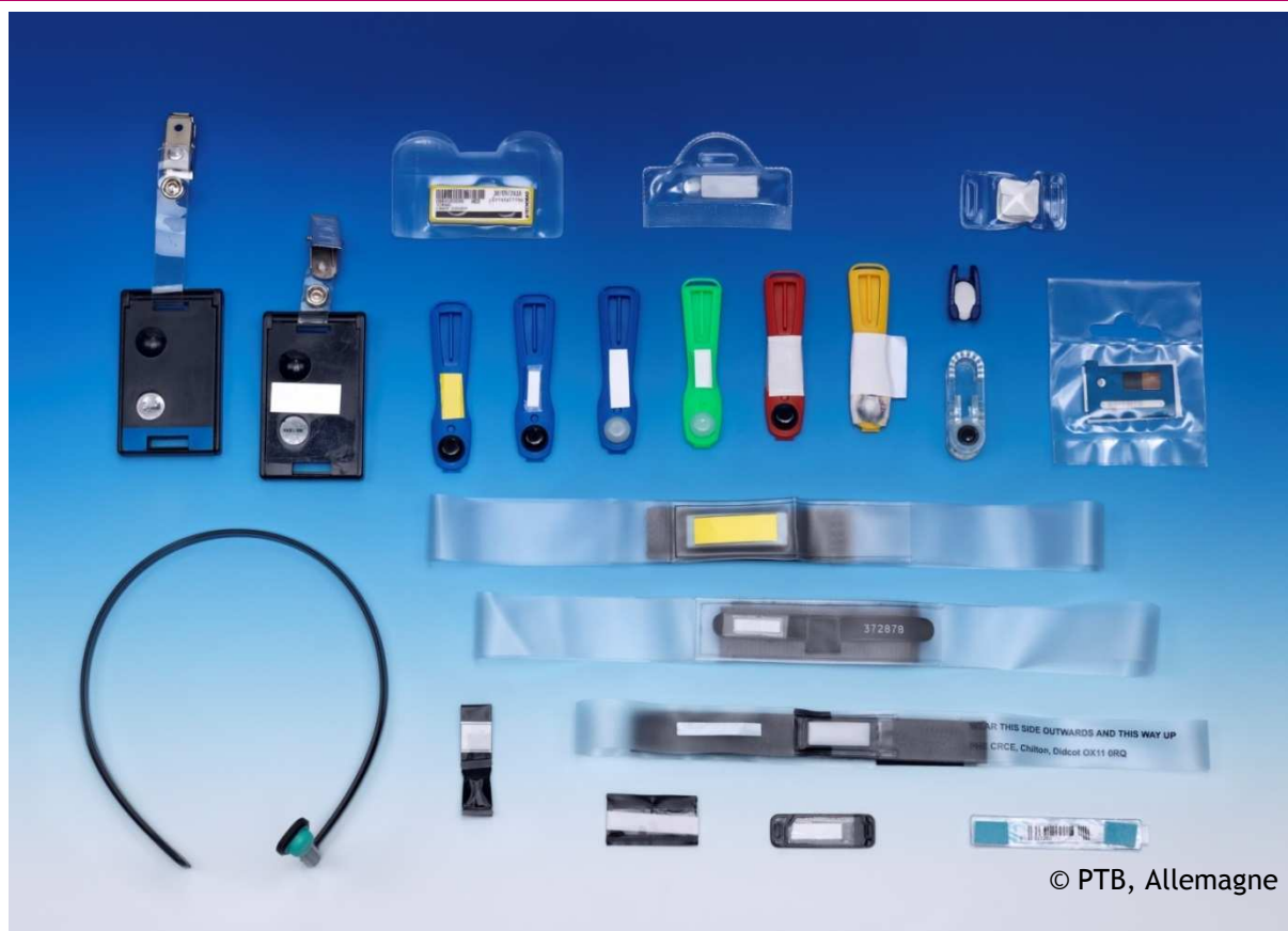
Les différents dosimètres cristallins ayant participé à l'intercomparaison organisée par l'EURADOS en 2016 (IC2016eye).
