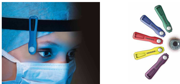
Figure 28 - Dosimètre passif EYE-DTM (RADCARD) dédié à la mesure de la dose au cristallin, développé dans le cadre du projet européen ORAMED
