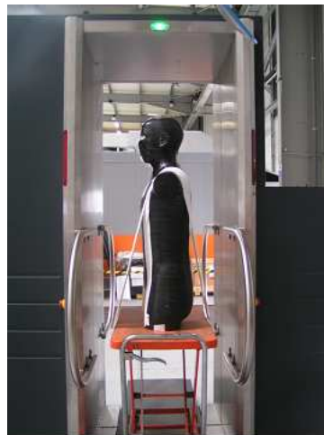
Figure 35 - Fantôme anthropomorphe équivalent tissu de type ALDERSON-RANDO lors d'un contrôle avec le Body Scanner BS 16HR DV ®
