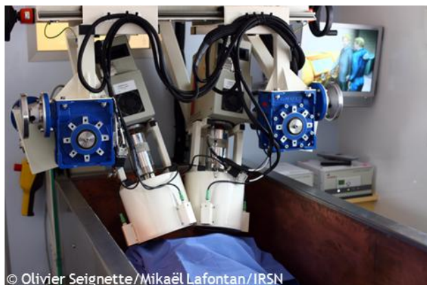
Figure 1 - Mesure anthroporadiométrique pulmonaire à l'aide de détecteurs GeHP
