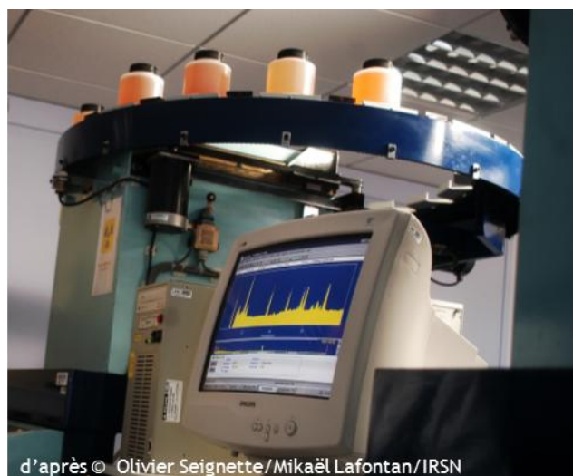
Figure 2 - Mesure de la radioactivité au sein d'échantillons urinaires par spectrométrie \gamma dans le cadre d'analyses radiotoxicologiques
