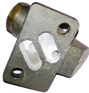
Fig. 3.2 / Encrassement de l'entrée d'air comprimé du positionneur d'un robinet pneumatique réglant par de la poudre d'alumine.
