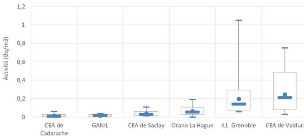
Figure 191. Activités en HTO dans l'air sur la période 2018-2019 pour les sites équipés d'un piègeur passif et/ou d'un barboteur
