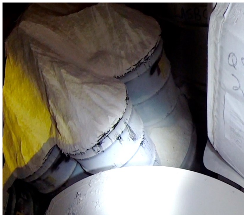
Figure 20 : Photographie des dégâts autour du colis 68660 L'image montre l'oxyde de magnésium en vrac au-dessus des colis (source DOE [34])
