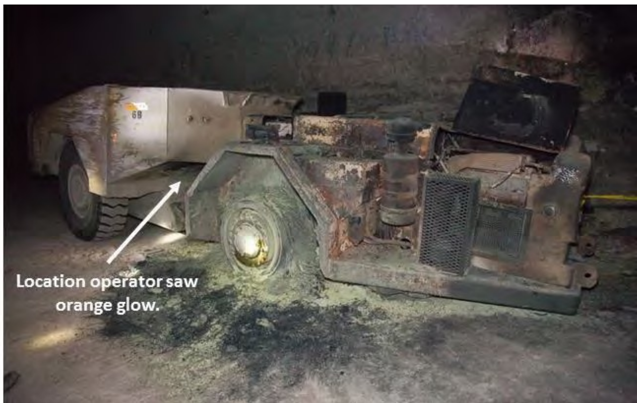
Figure 14 : état du véhicule minier après l'incendie La flèche indique le lieu où l'opérateur a vu la lueur orange. (source DOE [55])
