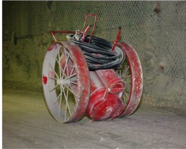
Figure 13 : extincteur à deux roues (140kg) (source DOE [55])
