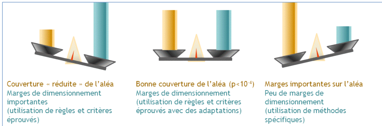
Figure 4 : Couplage entre niveau d'aléa et critères-méthodes de dimensionnement des SSC du noyau dur
