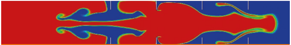
Simulation d'une expérience ENACCEF 2: flamme se développant dans un tube fermé en présence d'obstacles (rouge: zone brûlée, bleu: gaz frais). La structure complexe du front est due aux changements de sens de l'écoulement engendrés par les réflexions d'ondes de choc sur les extrémités fermées du tube.
