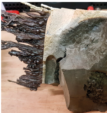
Résultat de la découpe par laser d'un morceau de simulant de corium hors cuve.
