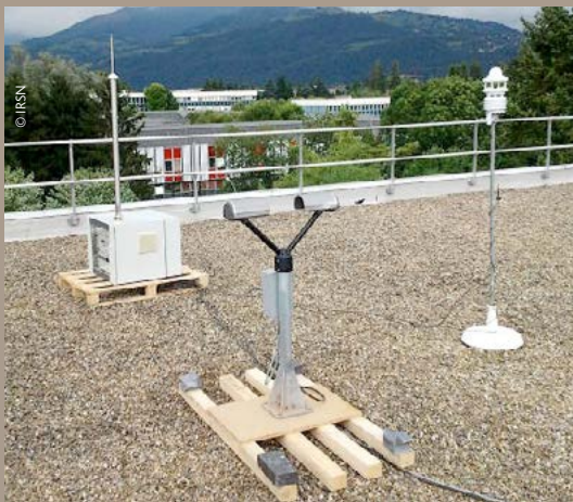
Les mesures in situ ont été réalisées grâce à l'association d'un granulomètre GL0 pour la mesure des concentrations volumiques d'aérosols et d'un disdromètre GL0 laser pour déterminer les caractéristiques des précipitations (G. Depuydt).
