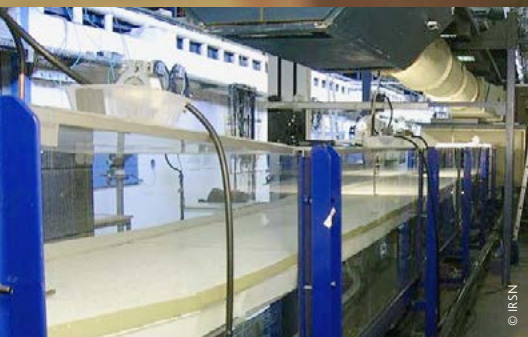
Soufflerie de l'Irpe avec un échantillon d'enduit de façade (thèse de P. Roupsard).
