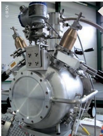
© IRSN Prototype de détecteur à protons de recul \mu TPC pour les particules à basse énergie, comprise entre 8 keV et 1 MeV.
