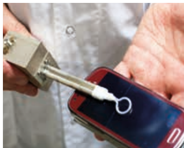
Antenne de surface permettant une mesure RPE du verre du portable sans avoir à démonter le téléphone.
