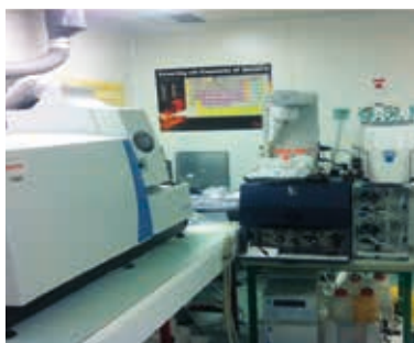
Chromatographie liquide (Dionex/ThermoFisher) couplée à l'ICP-MS : X-SERIES II (ThermoFisher).
