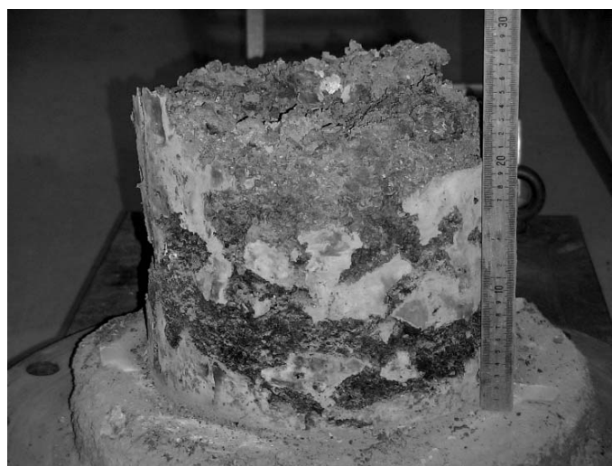
Figure 5.49. Aspect de la galette de corium resolidifié à la fin de l'essai SSWICS-11 réalisé avec une injection de gaz dans le corium [32], reproduit avec l'autorisation de l'OCDE.
