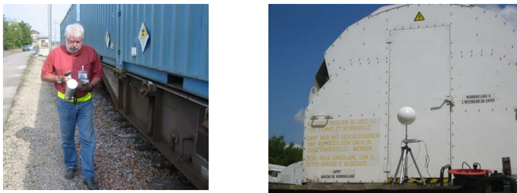
Figure 4 - Mesures dosimétriques et spectrométriques à proximité des convois de transport de matières radioactives.
