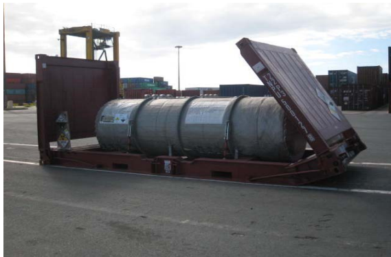
Figure 16 - Photo du « flat » endommagé lors de l'incident du 4 août 2008
