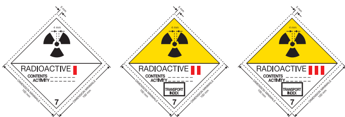
▽ Correspondance entre la catégorie des étiquettes apposées au colis, l'indice de transport et le débit de dose
