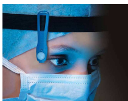
Prototype et version finale de dosimètre pour le cristallin (ORAMED)
