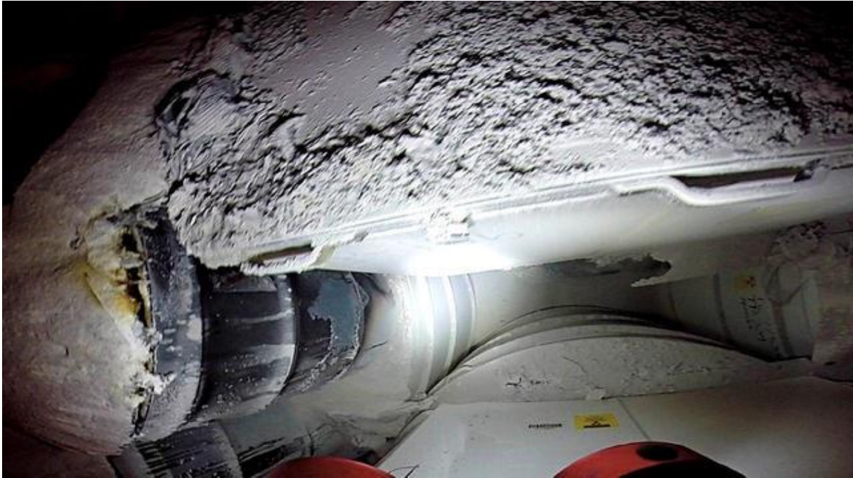
Figure 3 : photo de colis de déchets stockés pris du dessus. Le fût incriminé dans la fuite de radioactivité est au milieu à gauche de la photo [ http://www.wipp.energy.gov/pr/nr.htm ]
