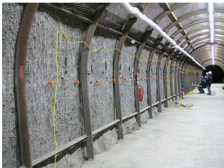
Capteurs sismiques déployés en paroi d'une galerie à Tournemire.
