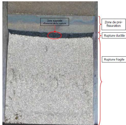
Figure 40 : Faciès de rupture typique d'une éprouvette CT25 testée à 50 °C et 330 °C
