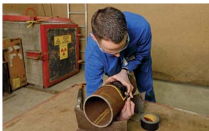
Un radiologue industriel contrôle une soudure réalisée par gammagraphie.
