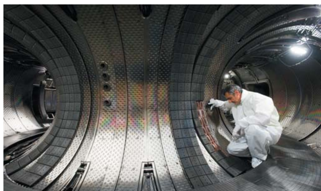
Vue de l'enceinte plasma de Tore Supra, tokamak en exploitation depuis 1988, où a été testée la supraconductivité des bobines.
