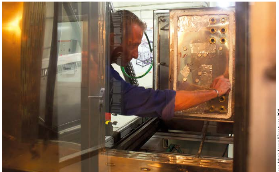
Des essais montrent que, en plus de la température, il fallait prendre en compte les fumées et dépôts de suies dans les critères de dysfonctionnement des équipements électriques importants pour la sûreté.
