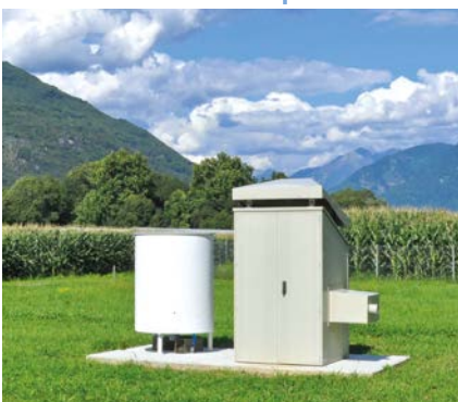
Station du collecteur aérosol à très grand débit 600 m 3 /h (à droite sur la photo) et du collecteur de pluie (à gauche) installés à Cadenazzo (canton du Tessin en Suisse).
