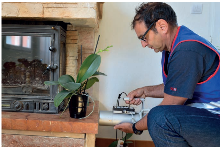
L'expert utilise une sonde à bas flux avec un radiamètre. Cet appareil permet d'effectuer des mesures de la radioactivité ambiante.
