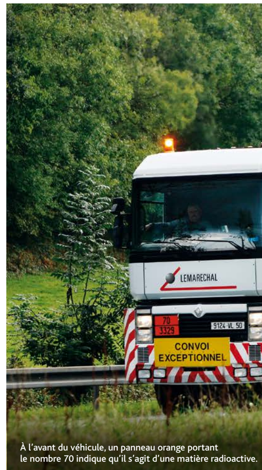
Signalétique sur un conteneur transportant des emballages de matières nucléaires.
