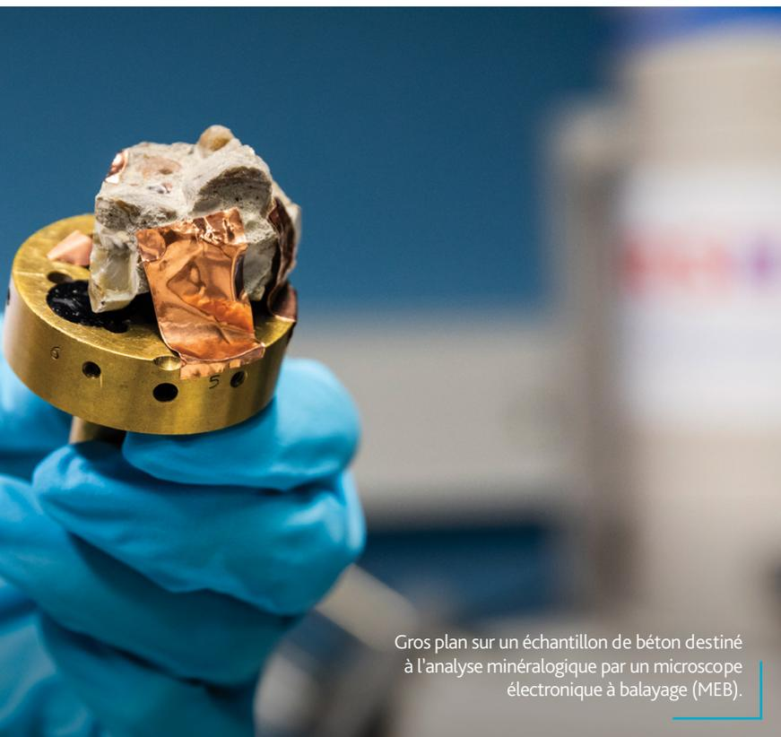
Gros plan sur un échantillon de béton destiné à l'analyse minéralogique par un microscope électronique à balayage (MEB).
