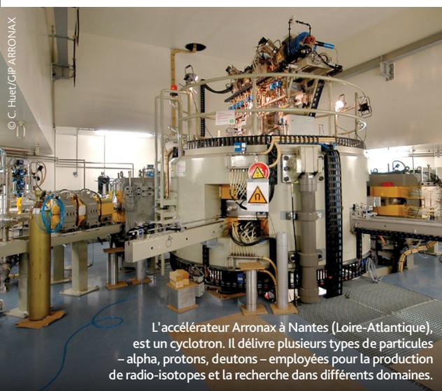
L'accélérateur Arronax à Nantes (Loire-Atlantique), est un cyclotron. Il délivre plusieurs types de particules – alpha, protons, deutons – employées pour la production de radio-isotopes et la recherche dans différents domaines.
