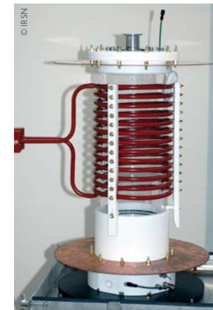
Dispositif Prelude : un cylindre de quartz contenant des billes d'acier chauffées par induction (solénoïde externe).
