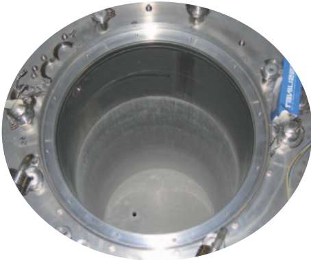
Cuve de l'appareillage B du Centre de recherche de Valduc (CEA). Une solution de plutonium de 14,3g/l à 22 °C est chauffée très lentement et de façon homogène jusqu'à 28 °C par l'eau du réflecteur situé dans le cylindre qui entoure la cuve. La réactivité est mesurée pour ces deux températures. L'expérience a duré 55 heures.
