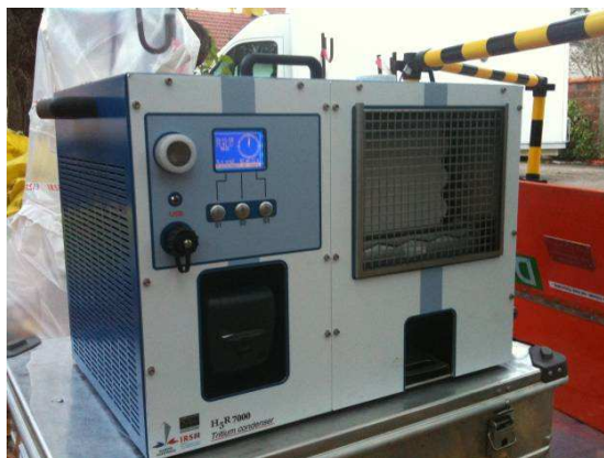
Photo du dispositif de prélèvement du tritium atmosphérique PRÉVAIR de l'IRSN installé à proximité du bâtiment de la société 2M Process à Saint-Maur-des-Fossés (94)
