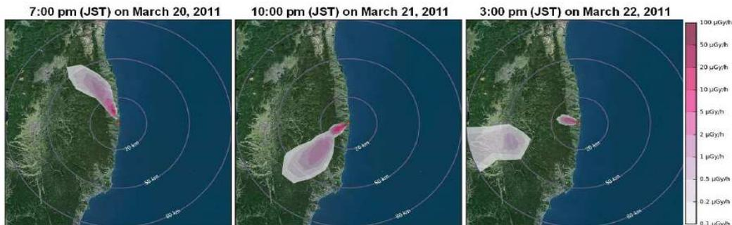
*Figure 2 : Modélisation du débit de dose ambiant résultant de la dispersion atmosphérique des rejets de l'accident de Fukushima entre le 20 et le 22 mars (hors contribution des dépôts radioactifs - modèle IRSN pX, échelle locale), illustrant le second épisode de contamination sur l'île de Honshu.*
