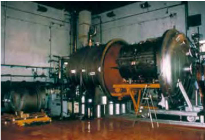
Four de l'expérience TÉNÉRIFE à l'ouverture de son enceinte de protection.
