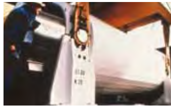
Chargement d'un colis de type B contenant des déchets vitrifiés.
