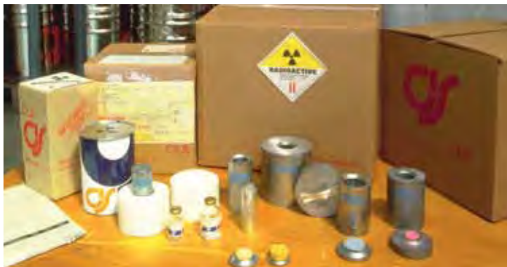
Colis de type A pour sources radiopharmaceutiques.
