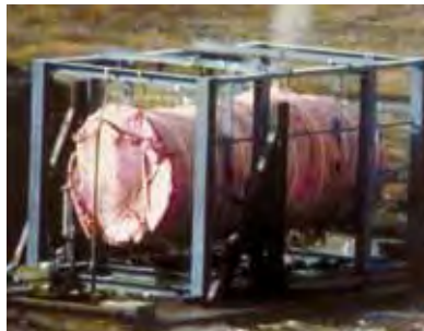
Dispositif de chauffage et de pressurisation d'un cylindre de transport d' UF_6 .
