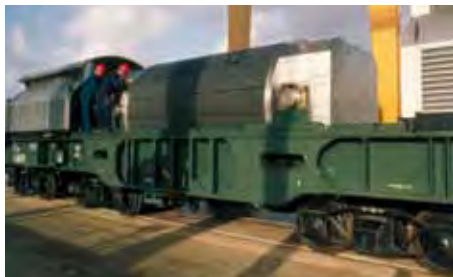
Wagons spécialisés pour le transport du combustible irradié.
