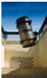
Essai de chute d'un prototype de cylindre 30B avec sa coque de protection.
