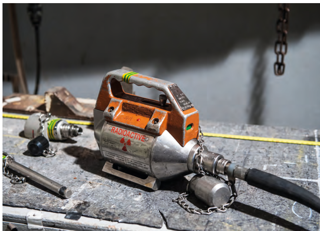
Figure 2.15 Projecteur de gammagraphie (modèle GAM80) contenant une source radioactive
