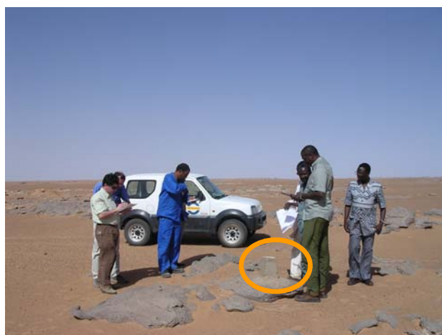
figure 9 : borne matérialisant l'emplacement d'un point de mesure d'une radiale (SOMAIR)
