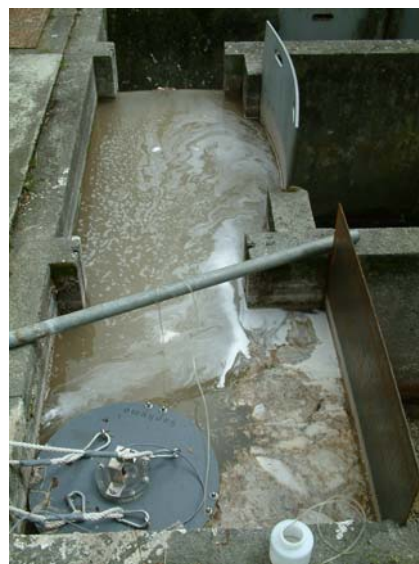
Figure 6 : Dispositif mis en place pour les mesures et l'intercomparaison
