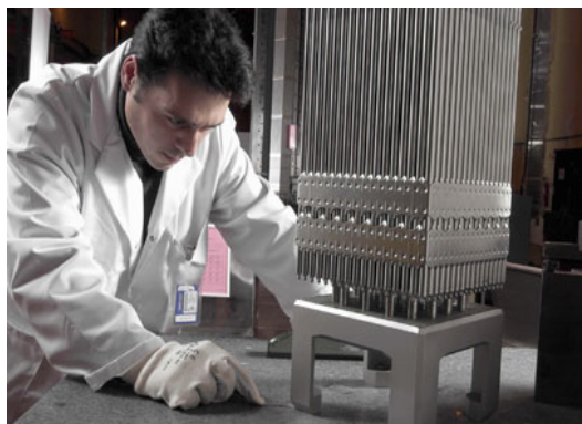
Assemblage renforcé, avec notamment sa grille de renfort en partie basse
