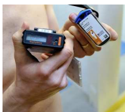
Dosimètre et film dosimétrique servent à la surveillance de la dosimétrie individuelle des travailleurs
