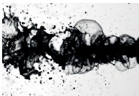
Spray en transition vers le flashing (Conditions : 5 mbar, 32^\circ\text{C} )
