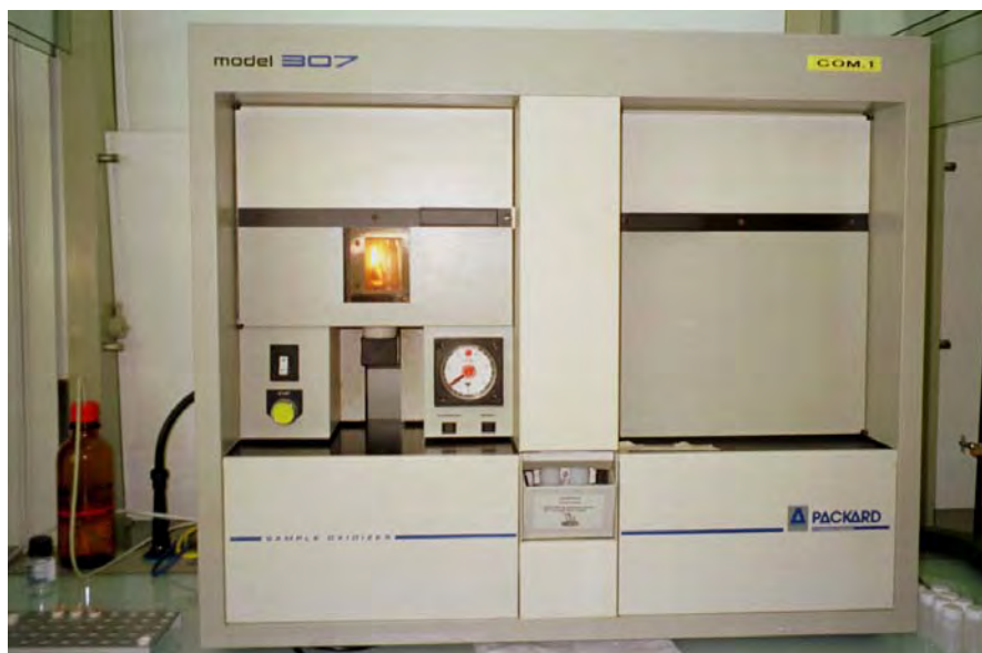
Dispositif « oxydiser » pour la combustion des échantillons solides et la récupération du tritium avant analyse
