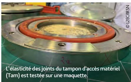
L'élasticité des joints du tampon d'accès matériel (Tam) est testée sur une maquette.
