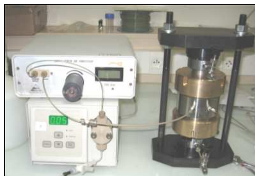
Figure 43 – Dispositif expérimental utilisé pour générer des interfaces fer/argile en conditions réductrices (Chautard, 2013).
