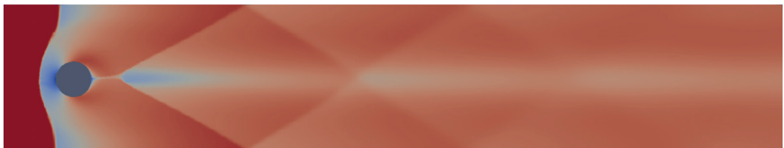
Simulation d'un écoulement en eau peu profonde derrière un cylindre
