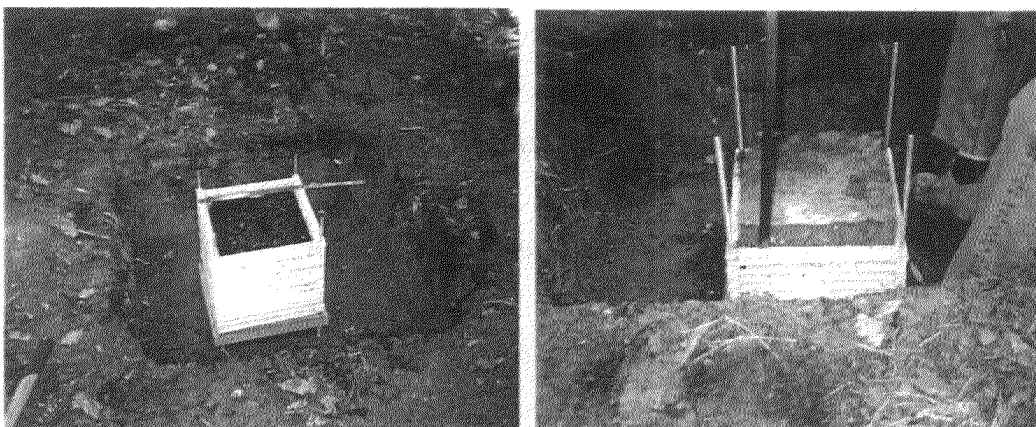
Figure II-2: Exemple de prélèvement d'un échantillon de sol de forêt par horizon de 5 cm.
