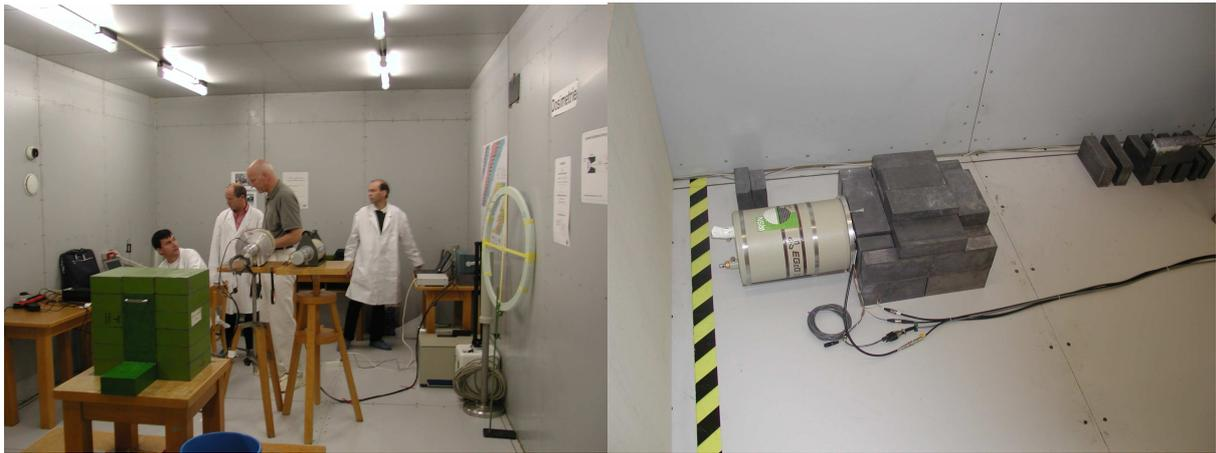
**Figure 3.24 : mesure du bruit de fond du détecteur dans la mine d'UDO.**
