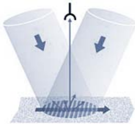
FIGURE F.1.2: Schématisation d'un volume de mesure et vue des franges d'interférence.
