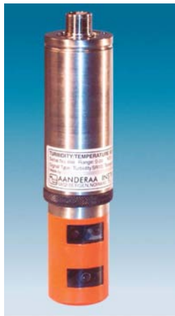
FIGURE 7.2.2: Photographie d'un turbidimètre, d'après Mylvaganam & Jakobsen (1998).
